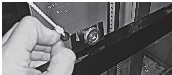
Sl. 8. Gurnite crni jezičak koji drži užu za vrata van stražnje strane držača valjka.
