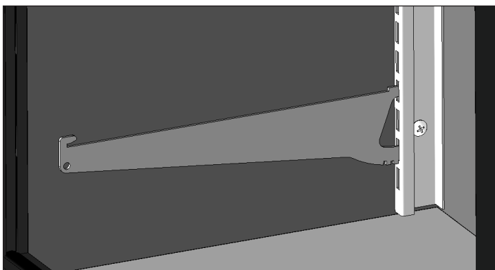
Fig. 4. Console de clayette installée.
