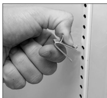
Rys. 1. Wkładanie górnego występu zacisku półki.
