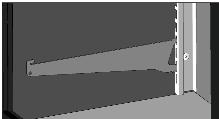
Rys. 4. Zamontować wspornik półki.
