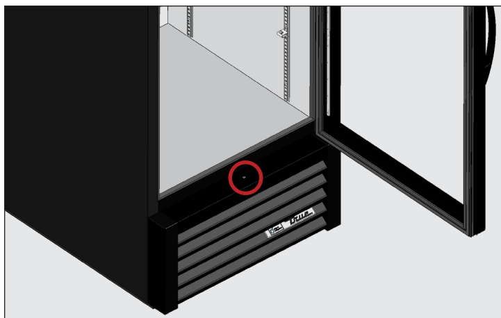
Rys. 1. Lokalizacja wkrętów kratki żaluzjowej w urządzeniach z drzwiami wahadłowymi.
