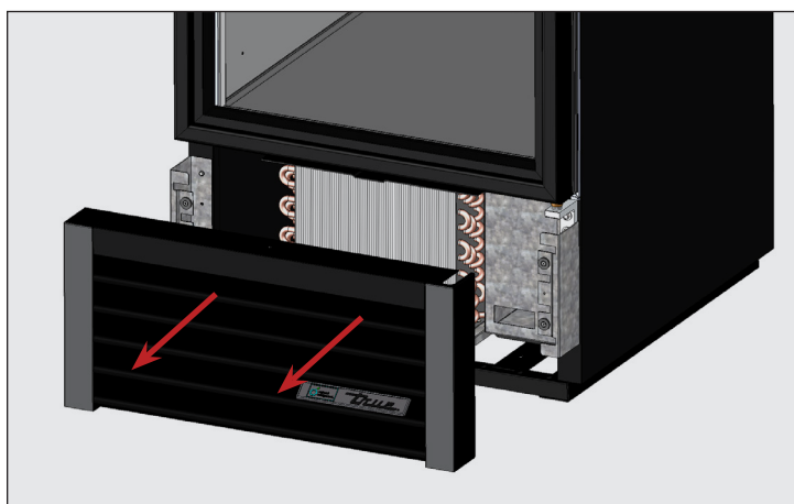
Rys. 3. Ostrożnie wymontować kratkę.
