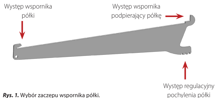
Rys. 1. Wybór zaczepu wspornika półki.
