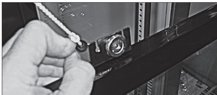
Rys. 8. Wysunąć z tyłu wspornika rolki czarny, plastikowy występ przytrzymujący linkę drzwiową
