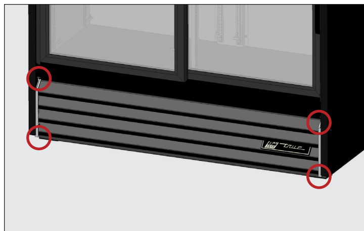
Rys. 2. Lokalizacja wkrętów kratki żaluzjowej w urządzeniach z drzwiami przesuwymi.
