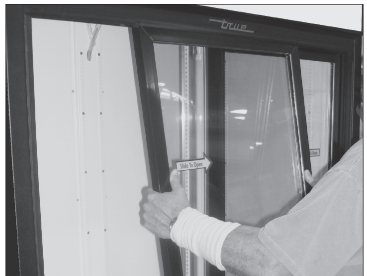
Fig. 4. Retire la puerta con cuidado.
