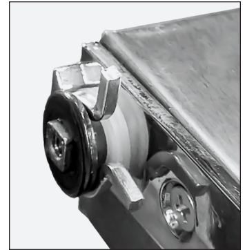
Afb. 7. Bewaar de lagers in de originele volgorde.
