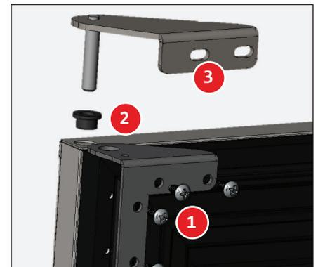
Fig. 7b. Componentes del conjunto de la bisagra superior.
