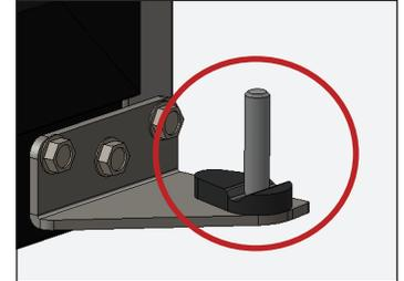
Fig. 3. Levante la puerta de la bisagra inferior.
