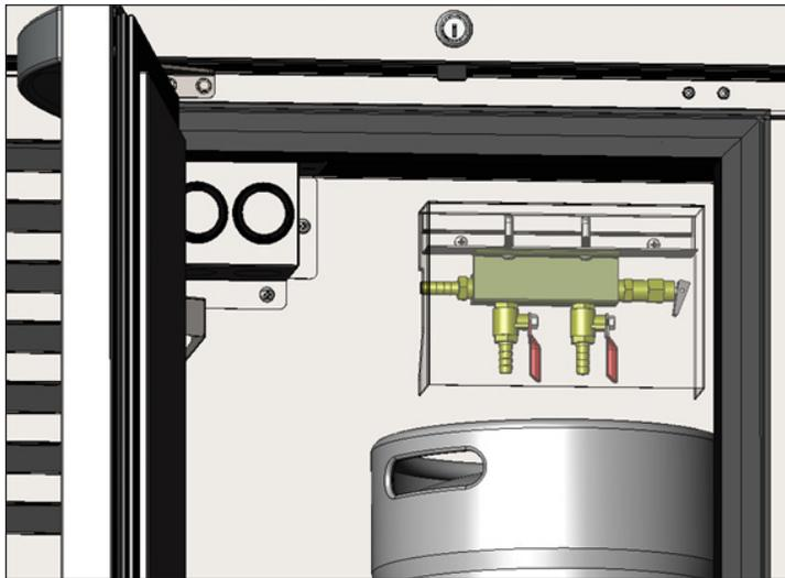
Fig. 2. El colector de distribución de 2 vías.
