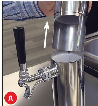
**Fig. 7.** Pase la manguera de aire por la torre de tiro desde abajo.
