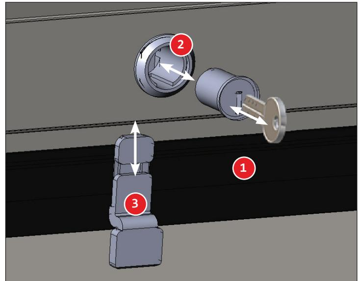
Fig. 1. Vista frontal del desmontaje/montaje de los componentes.
