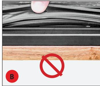
**Fig. 12.** Tire del lado de la junta para comprobar que la instalación es correcta.
