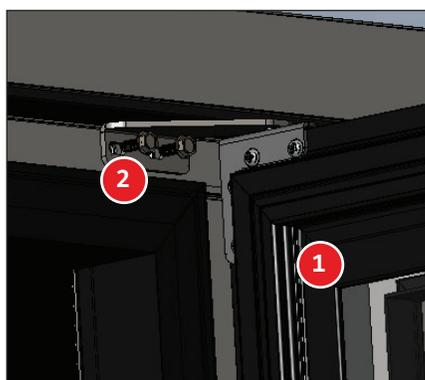
Fig. 10. Instale la bisagra superior y la puerta.
