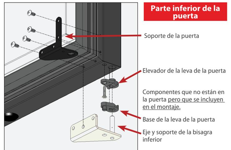
Fig. 4b. Componentes de la bisagra inferior.
