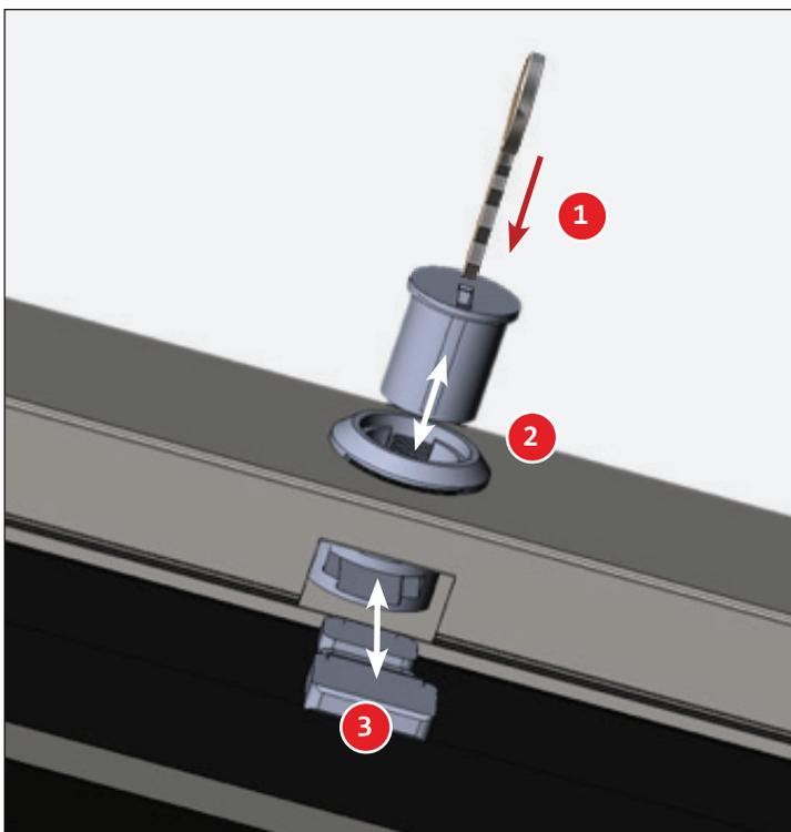
Fig. 2. Vista inferior del desmontaje/montaje de los componentes.
