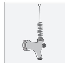
**Fig. 3.** Limpie a fondo los componentes del grifo.
