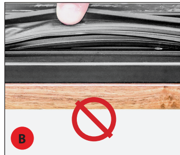
Afb. 12. Trek de pakking opzij, om de installatie ervan te controleren.
