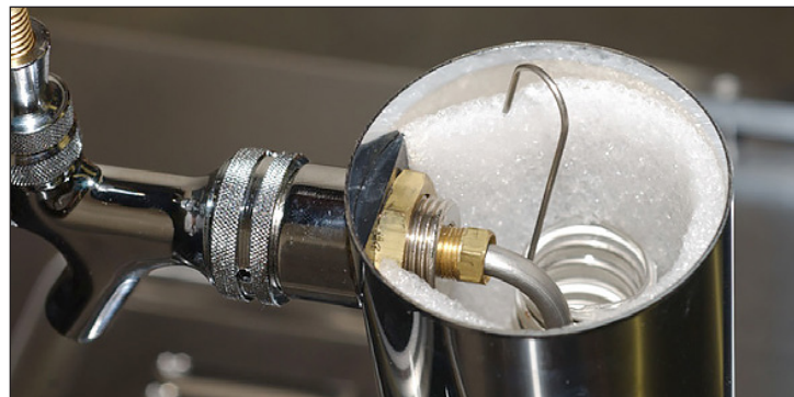
Afb. 8. Hang de koel slangklem over de bierleiding.
