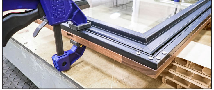
Afb. 6. Zorg ervoor dat de gleuf in het midden van de bekleding zich aan de bovenkant van de deur bevindt.
