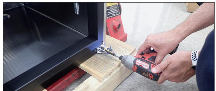
Afb. 7. Installeer het onderste scharnier aan de zijde tegenover de deuropening.
