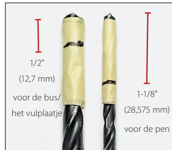
Afb. 8. Markeer de diepte van de gaten op de boren.
