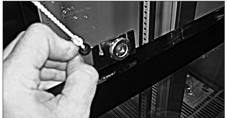
Afb. 6. Schuif het zwarte oogje met het deurkoord naar achteren uit de beugel.
