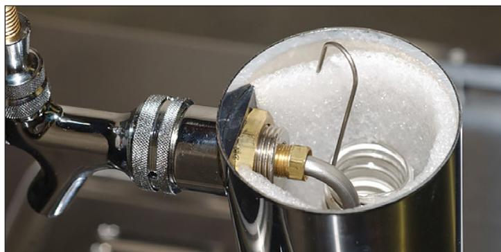
Rys. 8. Zawieszenie zacisku węży chłodzącego ponad linię piwa.
