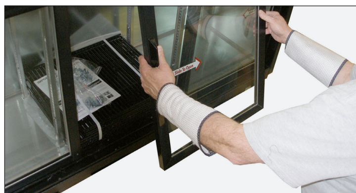
Rys. 2. Ostrożnie zdjąć drzwi.
