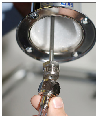
Rys. 3. Podłączenie złącza przewodu piwnego do ramienia nalewaka.
