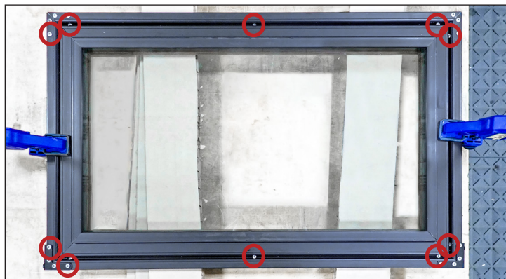
Rys. 7. Miejsca nawiercenia otworów w drzwiach szafy.
