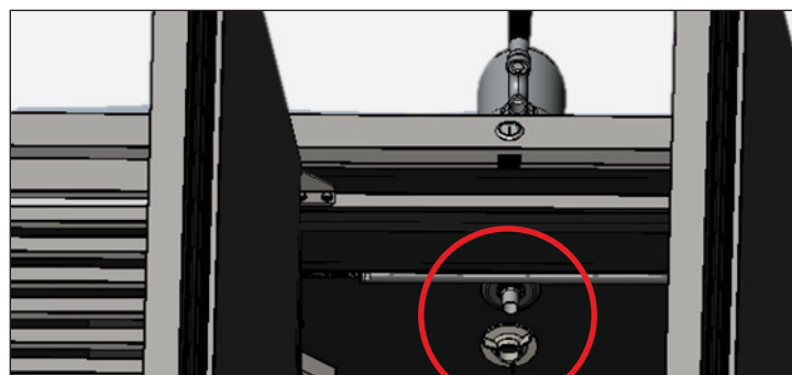
Rys. 1. Miejsce montażu nakrętki tacki ociekowej.
