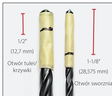
Rys. 8. Zaznaczyć głębokość otworów na wiertłach.
