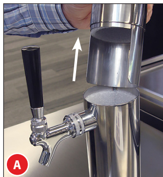
Rys. 7. Przeprowadzenie węża powietrza przez wieżę nalewaka od dołu.
