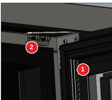
Rys. 10. Zamontować górny zawias i drzwi.
