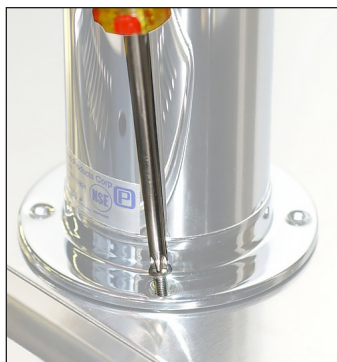
Rys. 5. Upewnienie się, że gumowa uszczelka znajduje się pomiędzy blatem a ramieniem nalewaka.
