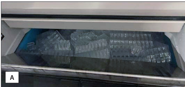
Afb. 5. Ijsbakken met (A) en zonder (B) een deflector voor de afgiftezone.
