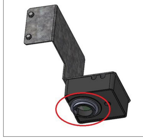
Afb. 2. Locatie van de lens van de ijsniveausensor.
