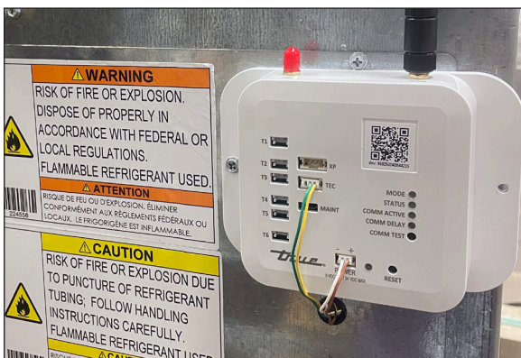
Afb. 2. Kabelboom aangesloten op modem. Groen/geel naar TEC; bruin/wit naar POWER (voeding).
