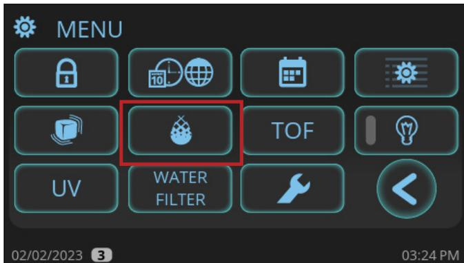
3. En la pantalla "Levels of water hardness or scale" [Niveles de incrustación o dureza del agua], ingrese la configuración deseada y luego presione "Okay" [Aceptar].
