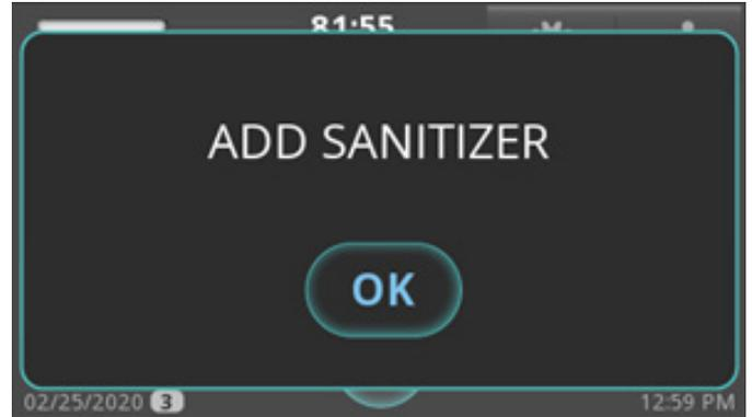
11. Después de agregar blanqueador de cloro (hipoclorito de sodio al 5,25 %), presione **OK [ACEPTAR]**. La pantalla mostrará entonces el estado de la secuencia.
