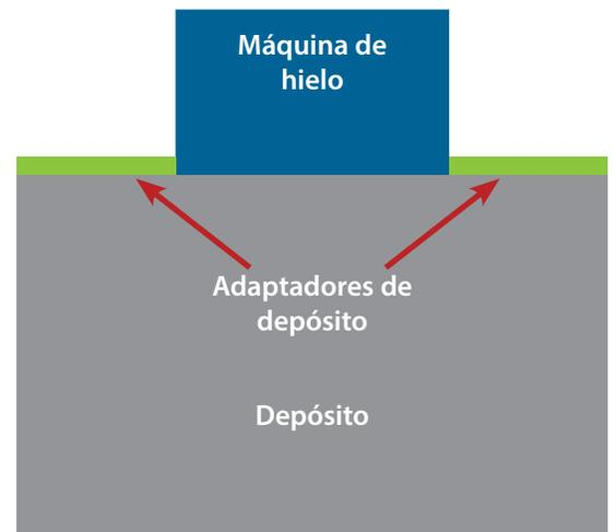
**Fig. 3.** Máquina de hielo centrada en el depósito.
