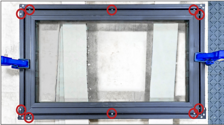
الشكل ٧. مواقع الفتحات مسبقة الثقب لباب الخزانة.
