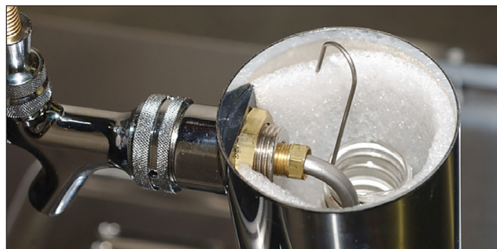
Afb. 8. Hang de koel slangklem over de bierleiding.
