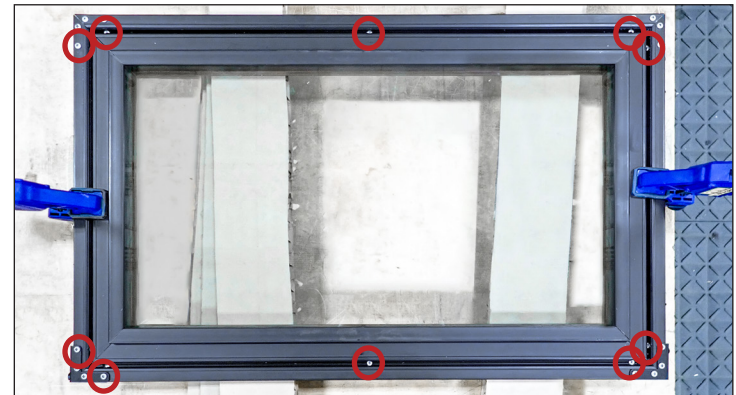
Afb. 7. Locatie van de voorgeboorde gaten in de deur.
