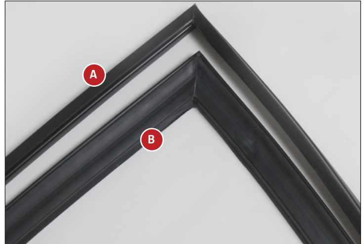
Afb. 1. Er zijn twee types pakkingen. A: smalle pakking; B: brede pakking.
