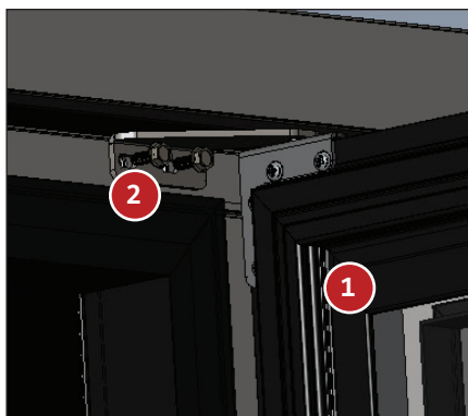
Afb. 10. Installeer het bovenste scharnier en de deur.
