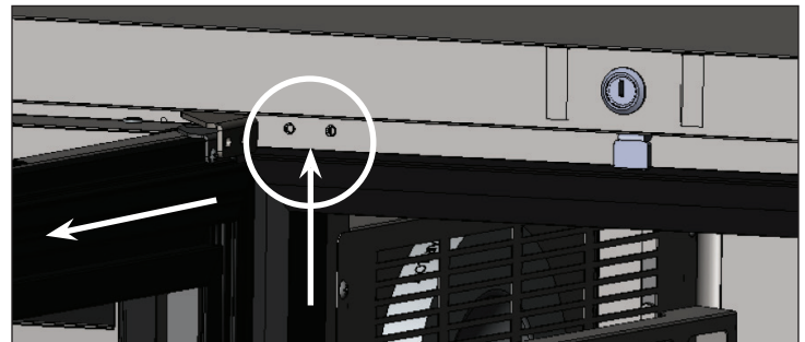
Fig. 2. Retrait de la charnière supérieure de l'unité.
