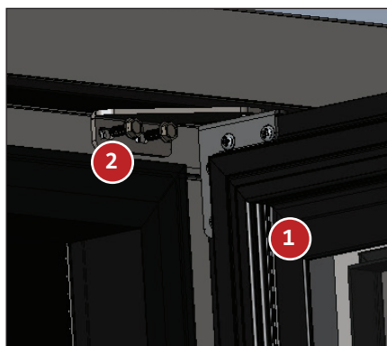
Fig. 10. Installez la charnière supérieure et la porte.
