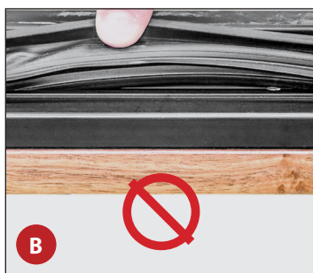
Fig. 12. Tirez sur le côté du joint pour vérifier son installation. A : CORRECT ; le canal du joint n'est PAS visible. B : INCORRECT ; le canal du joint est visible.
