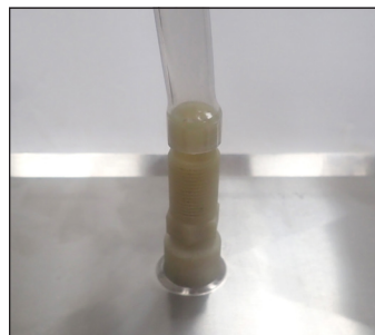
Fig. 5. Tuyau installé dans le tube du bac de rétention.
