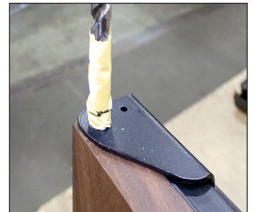
Fig. 9. Percez d'abord le trou de 3/8". ENSUITE, percez le trou de 17/64".
