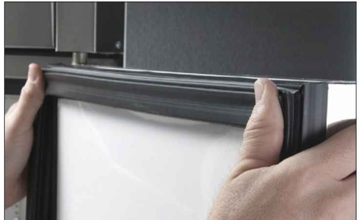
Fig. 4. Il est fréquent de voir du silicone poussé hors du rail autour du joint. C'est ainsi que vous savez que vous avez utilisé suffisamment de silicone.
