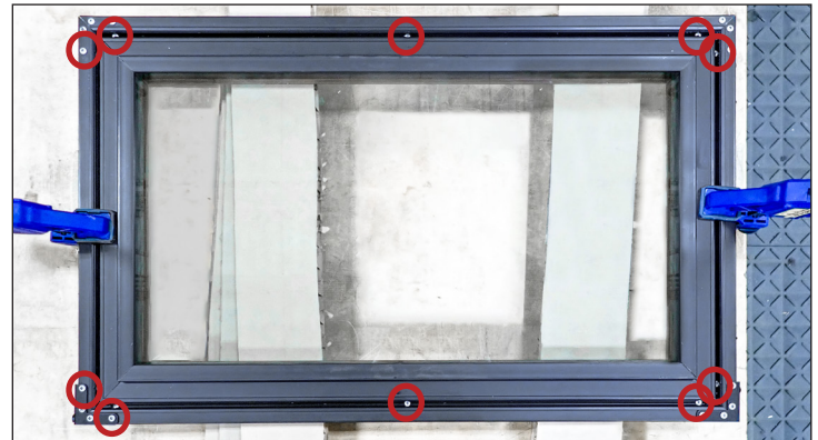
Abb. 7. Vorgebohrte Löcher in der Schranktür
