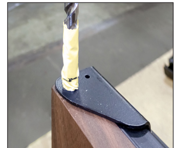
Abb. 9. Zuerst die 3/8"-Bohrung fertigen. DANN die 17/64"-Bohrung fertigen.
