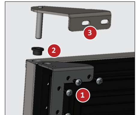
Abb. 7b Komponenten des oberen Scharniers
