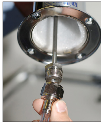
Abb. 3. Anbringen des Bierschlauchanschlusses an der Schanksäule
