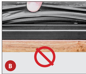
Abb. 12. Die Türdichtung zur Seite ziehen, um zu prüfen, ob sie in der Nut sitzt. A: RICHTIG; Dichtungsnut ist NICHT zu sehen. B: FALSCH; Dichtungsnut ist zu sehen.
