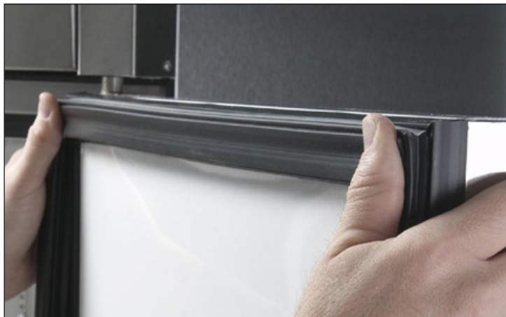
Fig. 4. È comune osservare del silicone che fuoriesce dalla guida di scorrimento, attorno alla guarnizione. Questa è la prova che è stato usata una quantità sufficiente di silicone.
