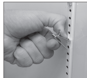
Fig. 2. La linguetta inferiore della clip per ripiani si fissa perfettamente.
