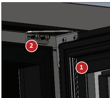
Rys. 10. Zamontować górny zawias i drzwi.
