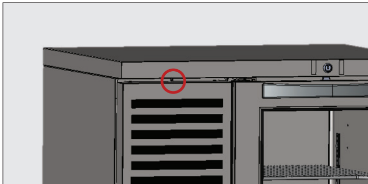
Rys. 1. Umieszczenie wkrętów kratki żaluzjowej.
