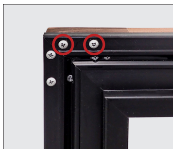
Rys. 10. Rozmieszczenie śrub uchwytów.
