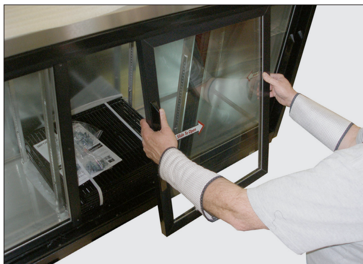
Rys. 2. Ostrożnie zdjąć drzwi.
