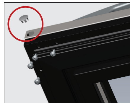
Rys. 6. Wyjąć zaślepki drzwi i pozostałe śruby.
