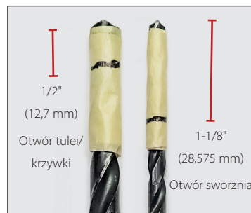
Rys. 8. Zaznaczyć głębokość otworów na wiertłach.
