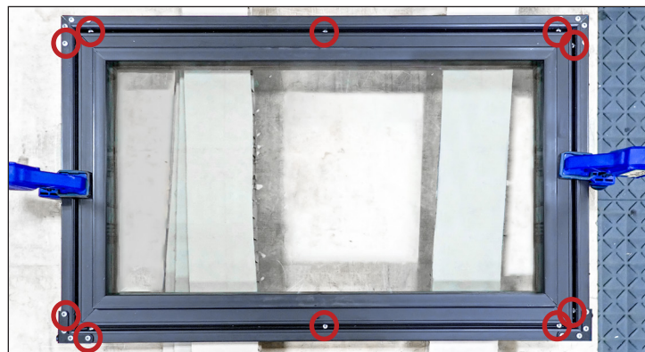
Rys. 7. Miejsca nawiercenia otworów w drzwiach szafy.
