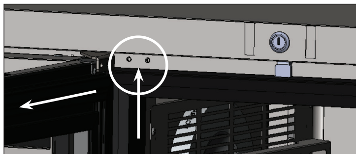
Rys. 2. Zdjąć górny zawias z urządzenia.
