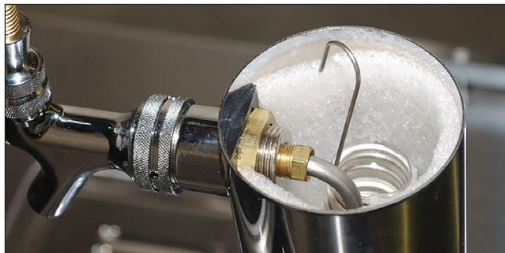
Rys. 8. Zawiesić zacisk węży chłodzącego ponad linię piwa.
