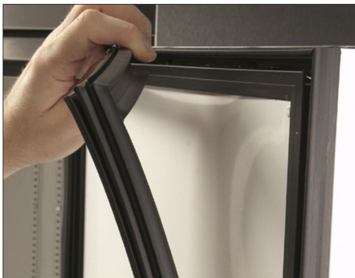
Rys. 2. Wyciągnąć uszczelkę zaczynając od górnego rogu.
