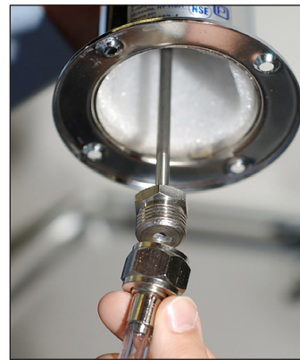
Рис. 3. Присоедините соединитель линии подачи пива к пивной колонне.
