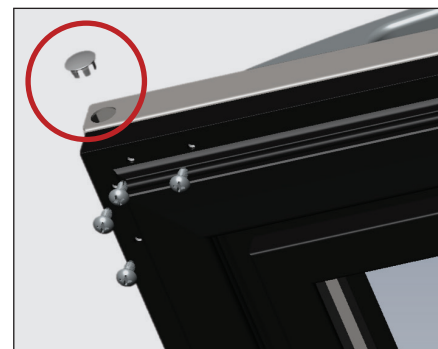
Рис. 6. Удалите заглушки двери и оставшиеся винты.
