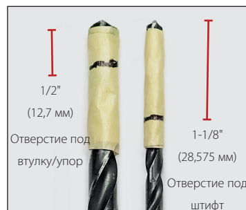
Рис. 8. Обозначьте глубину отверстий на сверлах.
