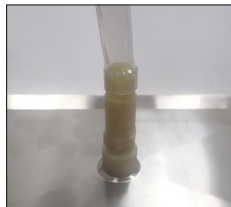
Рис. 5. Шланг установлен на трубке каплесборника.
