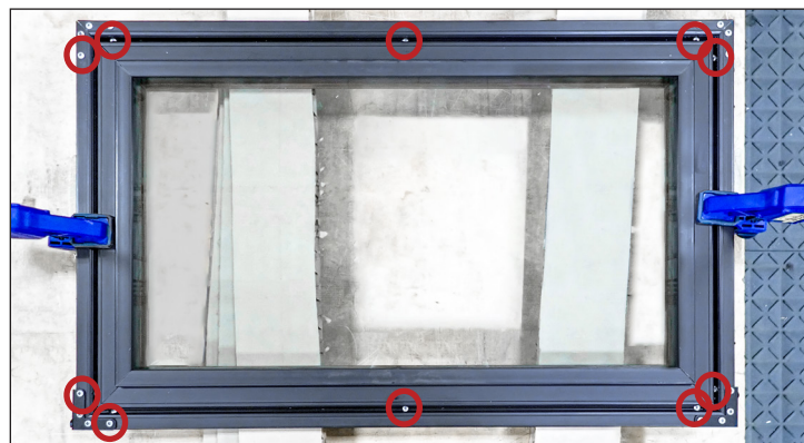
Рис. 7. Расположение предварительно просверленных отверстий двери шкафа.
