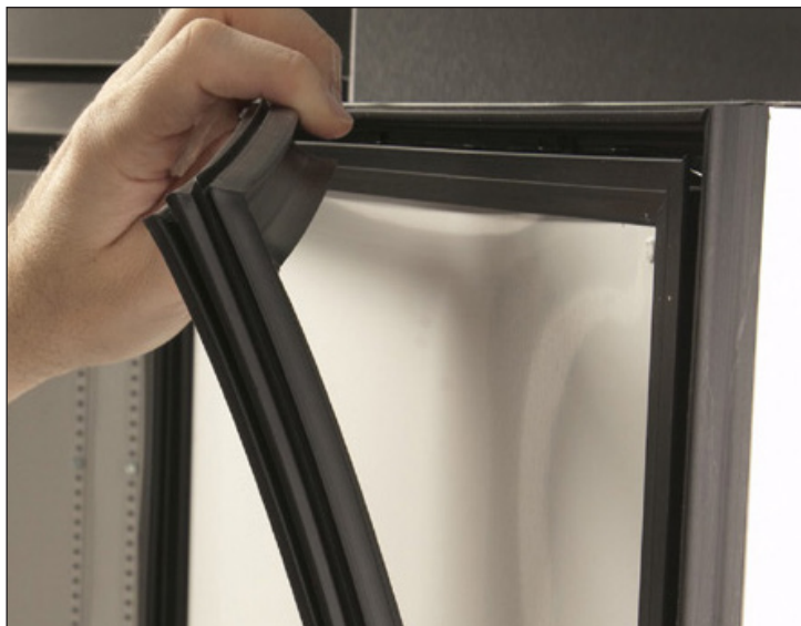
Рис. 2. Потяните за уплотнитель, начав в верхнем углу.
