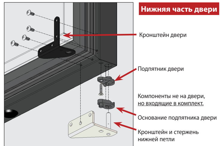
Рис. 4б. Компоненты нижней петли.
