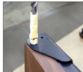
Рис. 9. Сначала просверлите отверстие 3/8". ЗАТЕМ просверлите отверстие 17/64".
