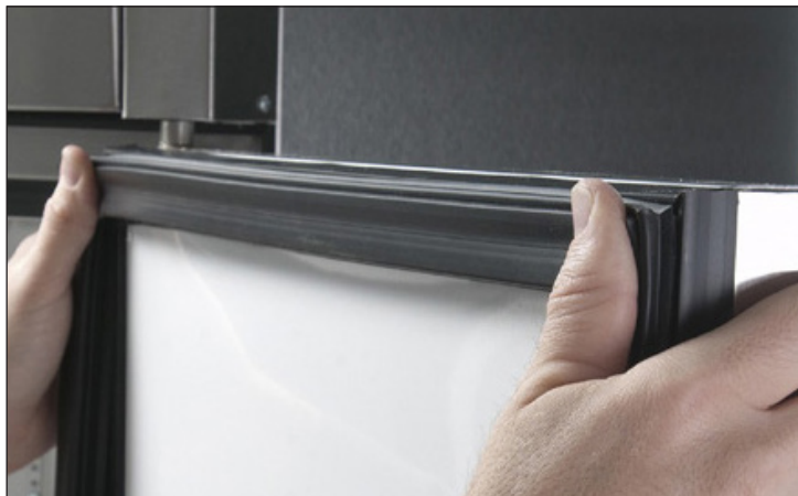
Рис. 4. Обычно можно видеть, как силикон выдавливается из направляющей рядом с уплотнителем. Это указывает на то, что было нанесено достаточное количество силикона.
