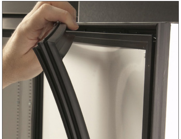
Fig. 2. Tire de la junta empezando por una esquina superior.
