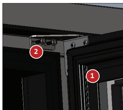
Fig. 10. Instale la bisagra superior y la puerta.
