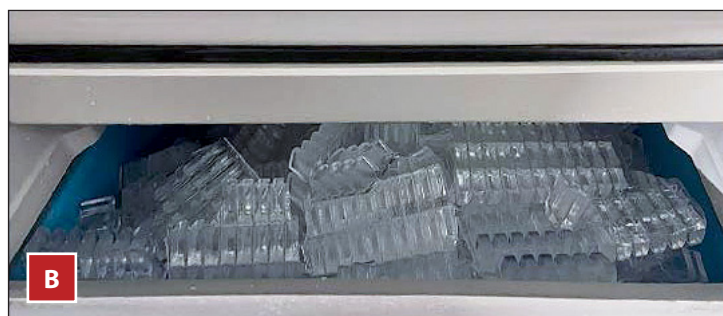
Afb. 5. Ijsbakken met (A) en zonder (B) een deflector voor de afgiftezone.
