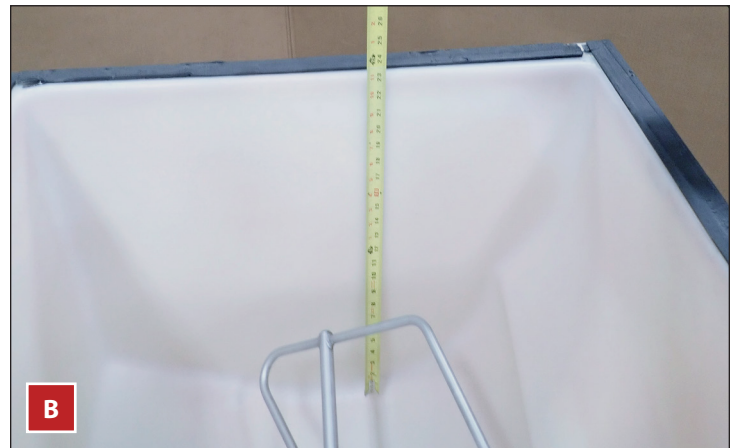
Rys. 2. Zawsze przed instalacją kostki do lodu wykonać pomiary zasobnika (A) lub dystrybutora (B) na potrzeby czujnika poziomu kostek lodu.
