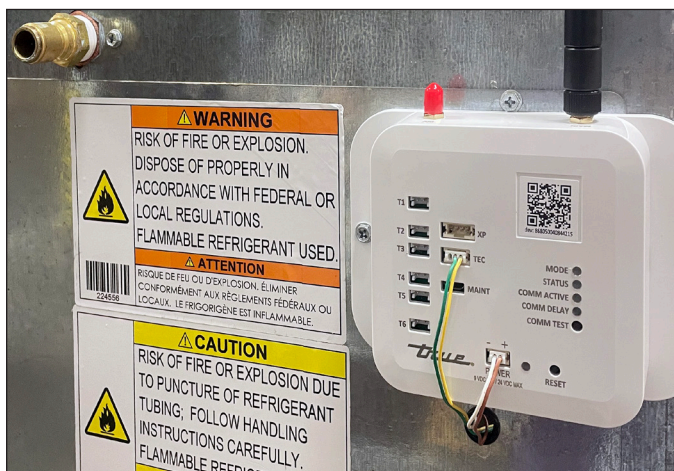
Rys. 2. Wiązka modemu podłączona do modemu. Zielony/żółty do TEC; brązowy/biały do ZASILANIA.
