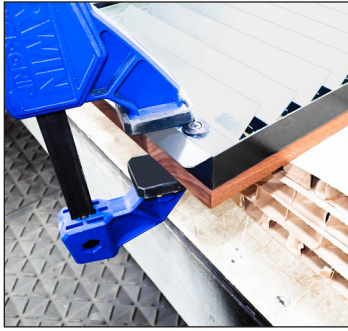
الشكل ٢. قم بتوسيط الكسوة والشبكة في الزوايا. تكون اللوحة أكبر قليلاً من الشبكة.
