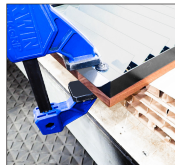
Afb. 2. Centreer de bekleding en het rooster bij de hoeken. Het paneel is iets groter dan het rooster.
