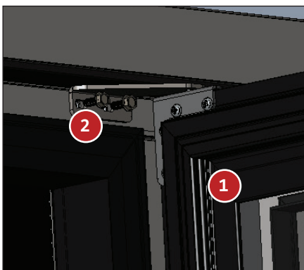
Afb. 10. Installeer het bovenste scharnier en de deur.
