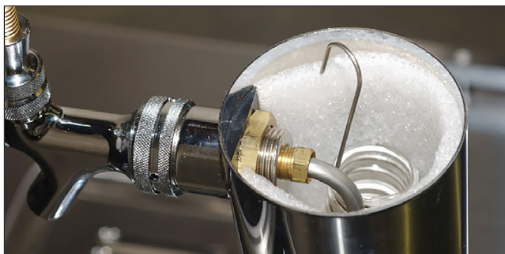
Afb. 8. Hang de koel slangklem over de bierleiding.
