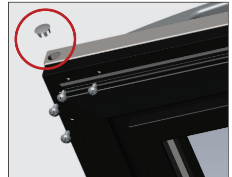
Abb. 6. Verschlussblenden und Schrauben aus der Tür entfernen
