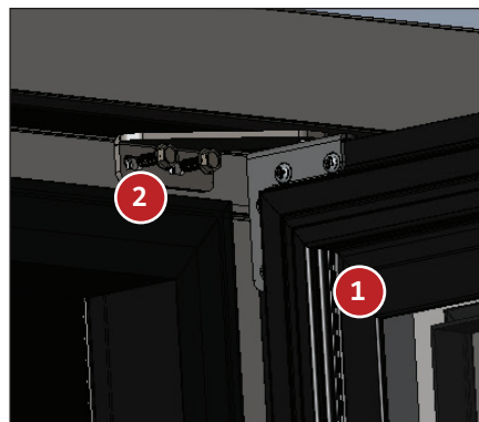
Abb. 10. Oberes Scharnier und die Tür anbringen
