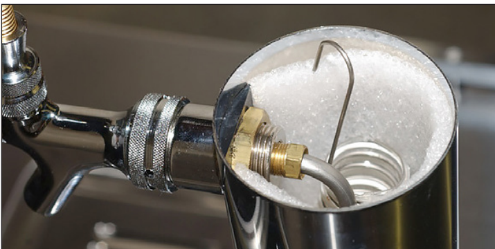
Abb. 8. Der Haken des Kühlschlauchs wird am oberen Rand der Isolierung eingehängt.
