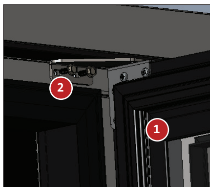
Fig. 10. Installare la cerniera superiore e lo sportello.
