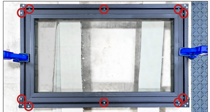
Fig. 7. Posizioni dei fori preforati nello sportello del refrigeratore.
