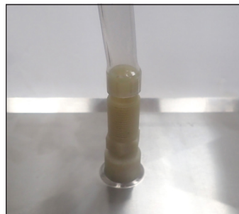
Fig. 5. Tubo flessibile installato sul tubo del vassoio di raccolta del liquido.
