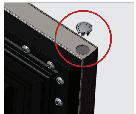
Fig. 11. Installare il tappo.
