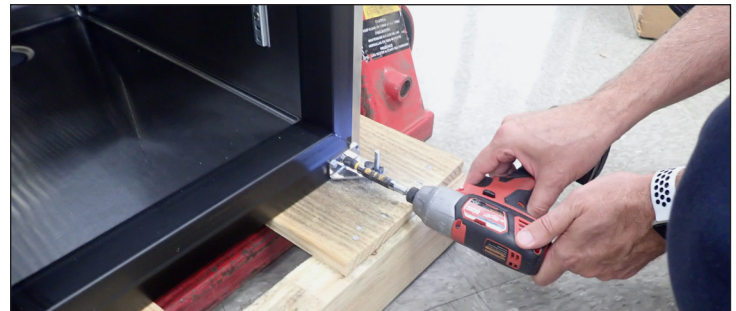
Fig. 7. Installare la cerniera inferiore sul lato opposto dell'apertura dello sportello.
