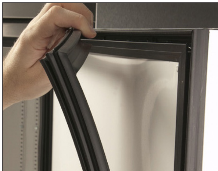
Rys. 2. Wyciągnąć uszczelkę zaczynając od górnego rogu.
