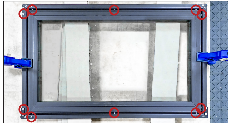
Rys. 7. Miejsca nawiercenia otworów w drzwiach szafy.
