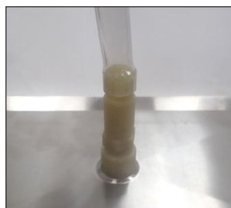
Rys. 5. Wąż zamontowany na tacce ociekowej.
