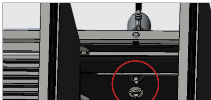
Rys. 1. Miejsce montażu nakrętki tacki ociekowej.
