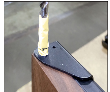
Rys. 9. Najpierw należy wywiercić otwór 3/8". NASTĘPNI e wywierć otwór 17/64".
