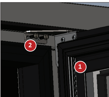
Rys. 10. Zamontować górny zawias i drzwi.
