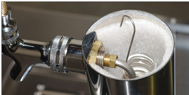
Rys. 8. Zawiesić zacisk węży chłodzącego ponad linię piwa.
