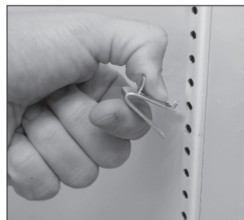
Rys. 1. Montaż górnego haczyka klipsa półki.
