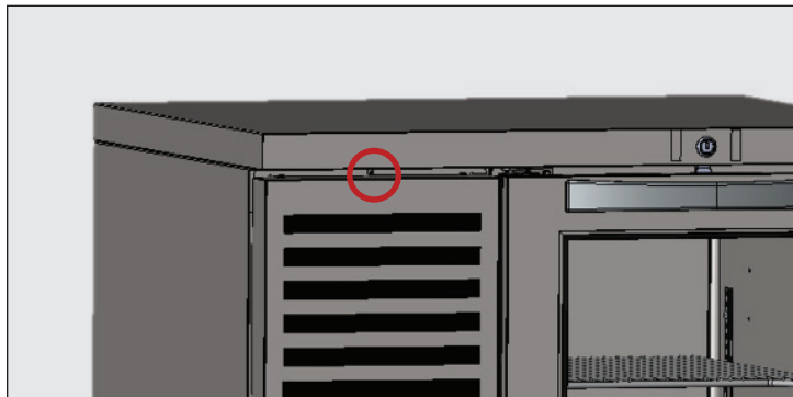
Rys. 1. Umieszczenie wkrętów kratki żaluzjowej.
