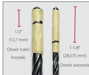
Rys. 8. Zaznaczyć głębokość otworów na wiertłach.
