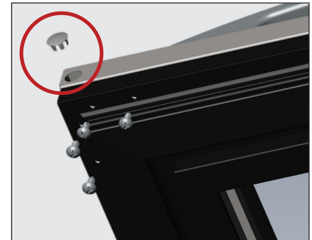
Fig. 6. Retire los tapones de la puerta y los tornillos restantes.
