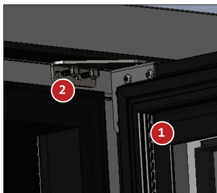
Fig. 10. Instale la bisagra superior y la puerta.
