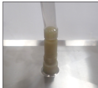
Fig. 5. Manguera instalada en el tubo de la bandeja de derrames.
