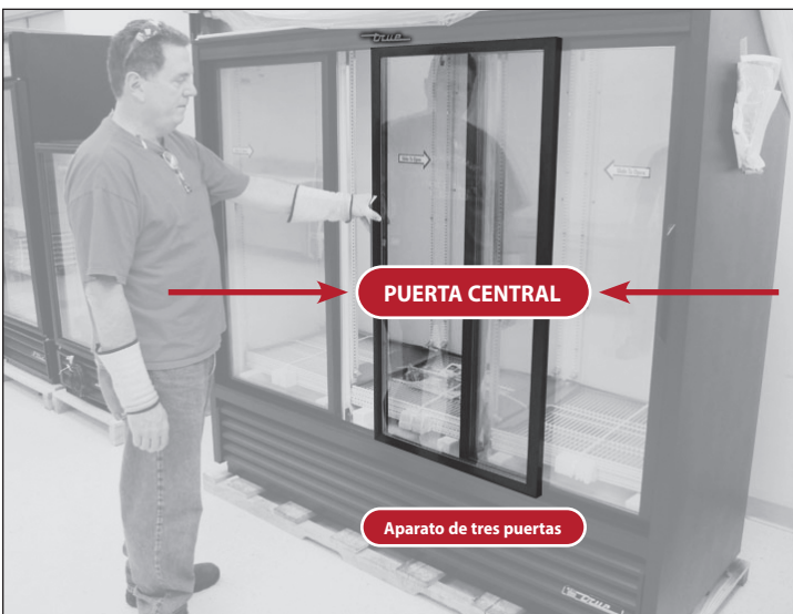
Fig. 3. Centre la puerta central en el borde izquierdo de la puerta derecha.
