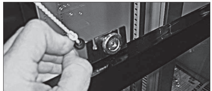
Fig. 8. Faites sortir du support du galet par coulissement par l'arrière la languette noire qui maintient le cordon de la porte.
