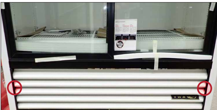
Fig. 3. Porte coulissante : Emplacements des vis de la grille de ventilation arrière.
