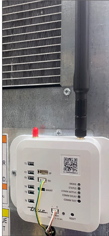
الشكل 3. تركيب الهوائي على جهاز الوصل. قد يختلف الهوائي الخاص بك.
