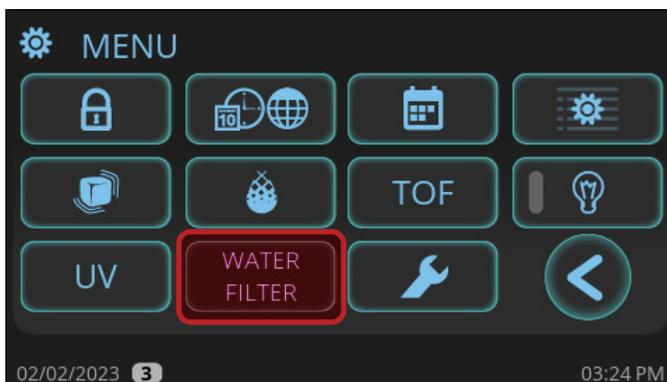
3. Sur l'écran **Filtre à eau**, sélectionnez le filtre à eau approprié à votre application. True propose des systèmes de filtration d'eau Standard et Platinum. En cas d'utilisation d'un filtre à eau d'origine autre que TRUE, saisissez la capacité en eau sous **PERSONNALISÉ**. Consultez les capacités des filtres dans le tableau.
