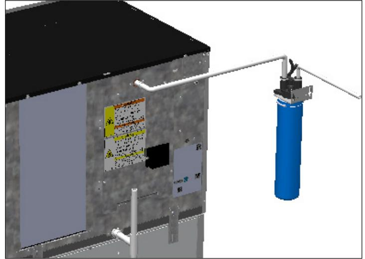
**Figure 1.** Exemple de raccordements de plomberie par le haut. Votre application peut être différente.
