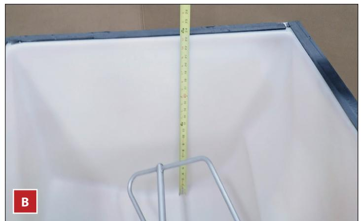
Figure 2. Mesurez toujours le bac (A) ou le distributeur (B) par rapport au capteur de niveau de glaçons avant le montage sur la machine à glaçons.
