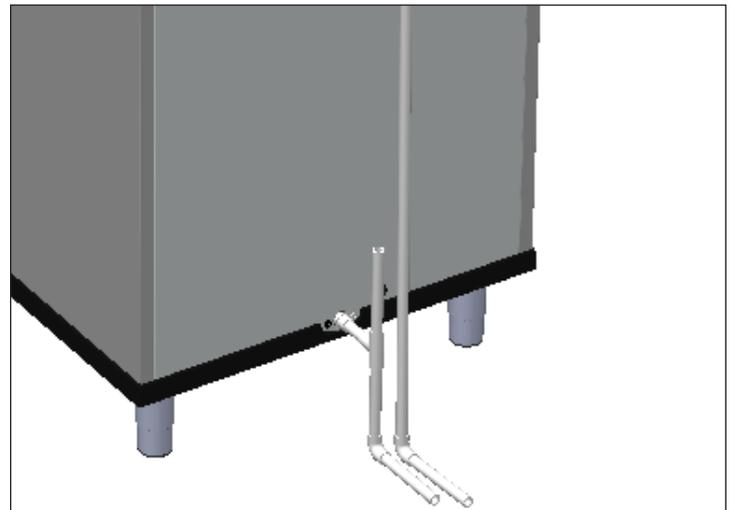
**Figure 2.** Exemple de raccordements de plomberie par le bas. Votre application peut être différente.
