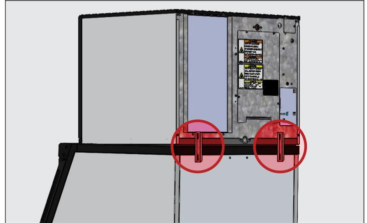
Figure 1. Supports de bac installés.
