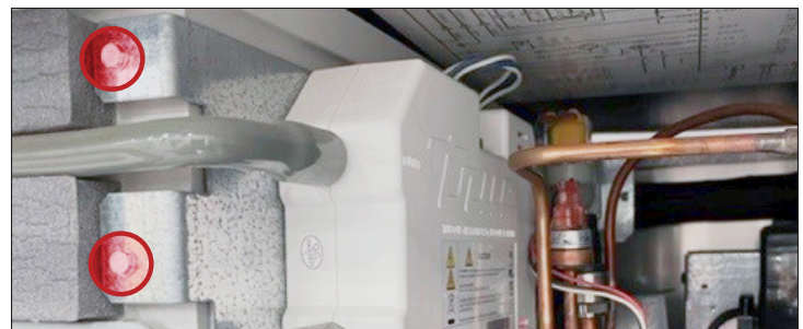
Abb. 3. Seitenansicht des TRUEZONE UV-Systems. Position der Schrauben der TrueZone-Halterung.
