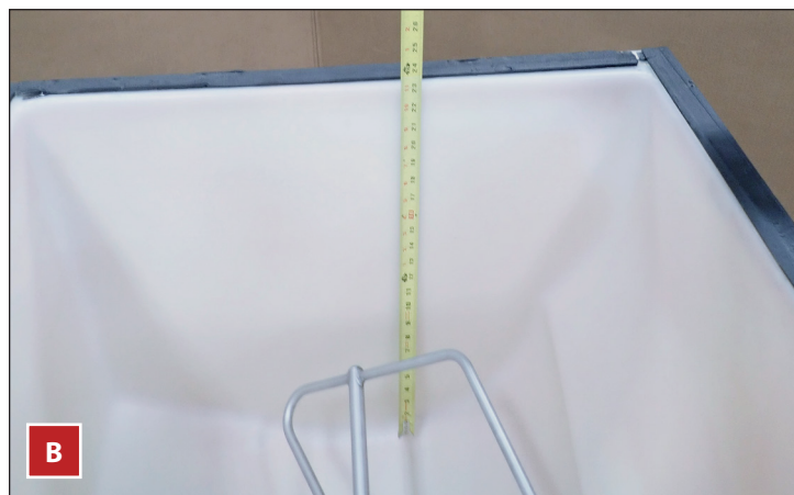
Fig. 2 Misurare sempre il contenitore (A) o l'erogatore (B) per il sensore del livello del ghiaccio prima di montare la macchina del ghiaccio.
