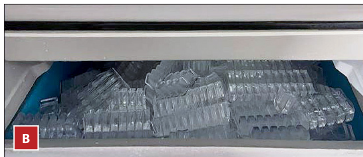
Fig. 5 Contenitori del ghiaccio con (A) e senza (B) un deflettore della zona di rilascio.
