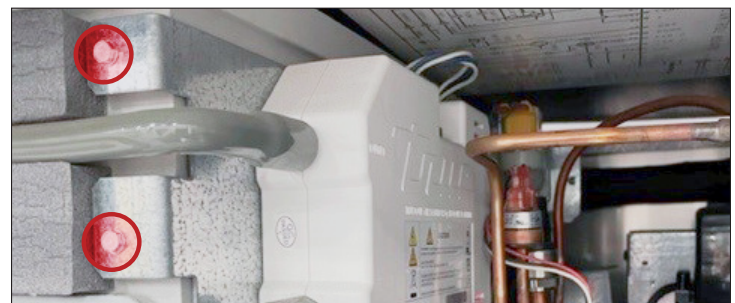
Fig. 3 Vista laterale del Sistema UV TRUEZONE. Ubicazioni delle viti della staffa TRUEZONE.
