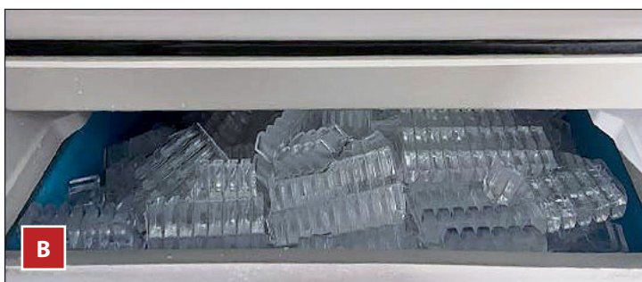
Afb. 5. Ijsbakken met (A) en zonder (B) een deflector voor de afgiftezone.
