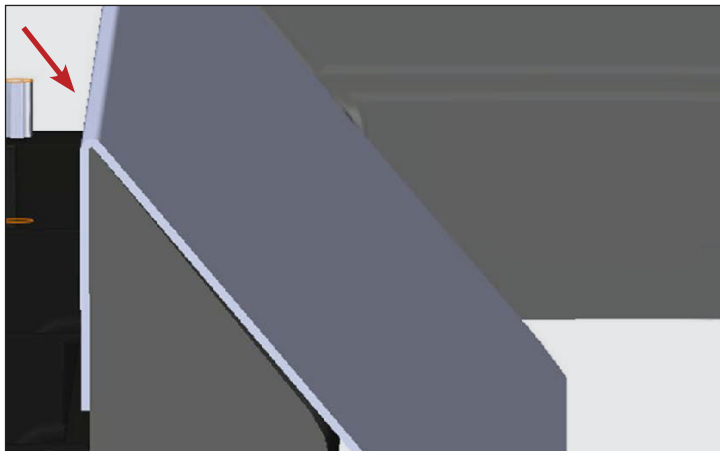
Afb. 4. Zijaanzicht met deflector voor afgiftezone aangebracht.
