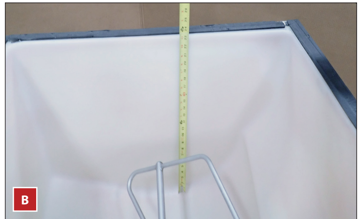
Rys. 2. Zawsze przed instalacją kostkarki do lodu wykonać pomiary zasobnika (A) lub dystrybutora (B) na potrzeby czujnika poziomu kostek lodu.
