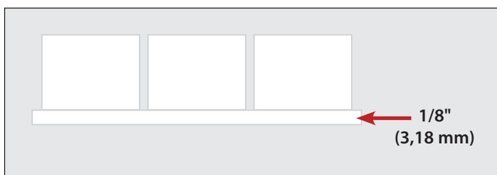
Rys. 1. Mostek lodowy scala kostki lodu w bloku.
