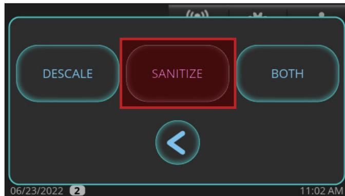
8. Когда на дисплее высвечивается сообщение «**Would you like the unit to start making ice once descaling and/or sanitizing is complete?**» («Хотите ли вы, чтобы устройство начало производить лед после завершения удаления известкового налета и/или дезинфекции?»), нажать **NO (нет)** или **YES (да)**. Ледогенератор переходит в режим предварительной очистки (PRE-CLEANING).
