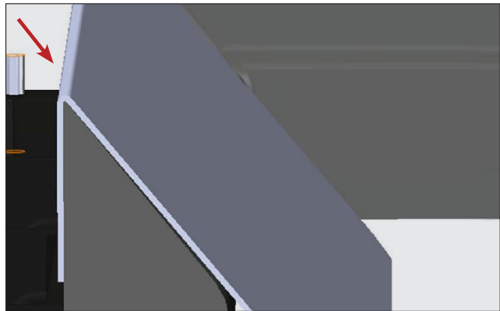
Fig. 4. Vista lateral del deflector de zona de caída instalado.
