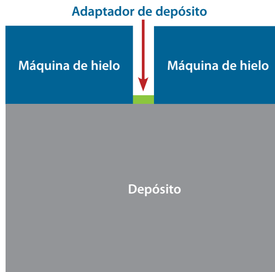
Fig. 2. Máquinas de hielo instaladas a ambos costados del depósito.
