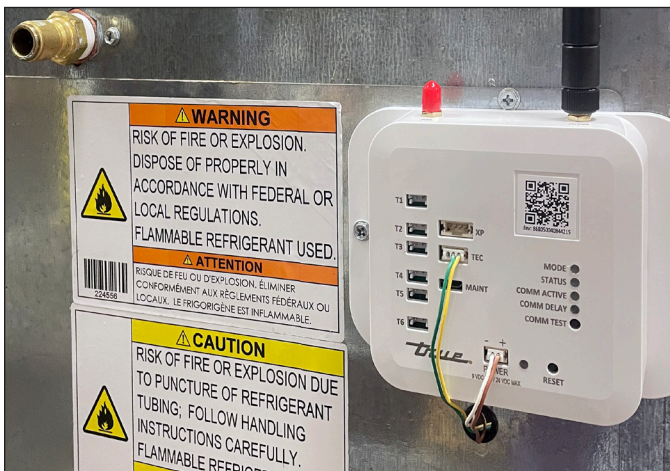
Fig. 2. Arnés de cables conectado al módem. Verde/amarillo a TEC; marrón/blanco a POWER.
