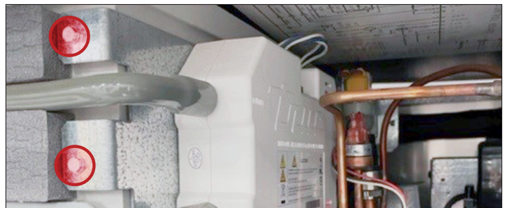
Fig. 3. Vista lateral del sistema de luz ultravioleta de TrueZone. Ubicaciones de los tornillos del soporte de TrueZone.
