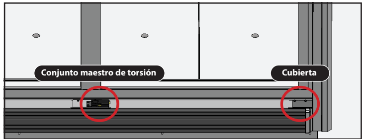
Fig. 25. Ubicación del conjunto maestro de torsión original y de la cubierta.
