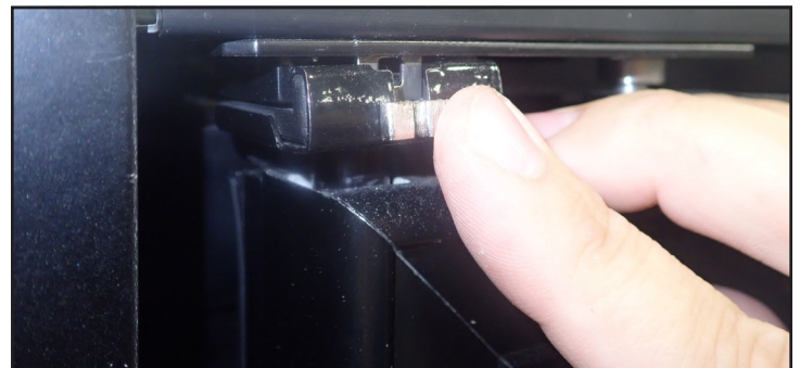
Fig. 12. Inserte el clip de retención de la bisagra.
