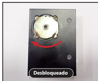
Fig. 26. Mueva el maestro de torsión hacia la placa de repuesto. Gire en sentido antihorario para bloquear y en sentido horario para desbloquear.
