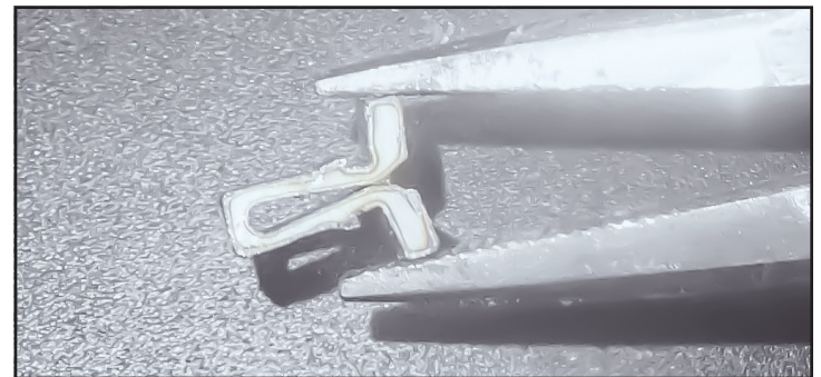
Fig. 10. Apriete el clip de retención de la bisagra.
