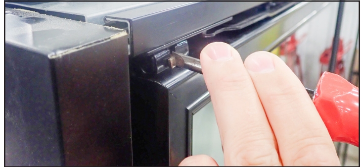
Fig. 14. Abra el clip de retención de la bisagra.
