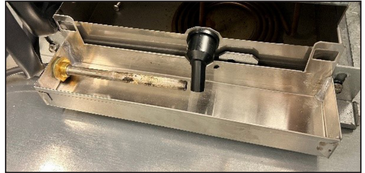
Fig. 2. Coloque la BDC debajo de la boquilla de drenaje.
