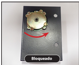
Fig. 26. Mueva el maestro de torsión hacia la placa de repuesto. Gire en sentido antihorario para bloquear y en sentido horario para desbloquear.
