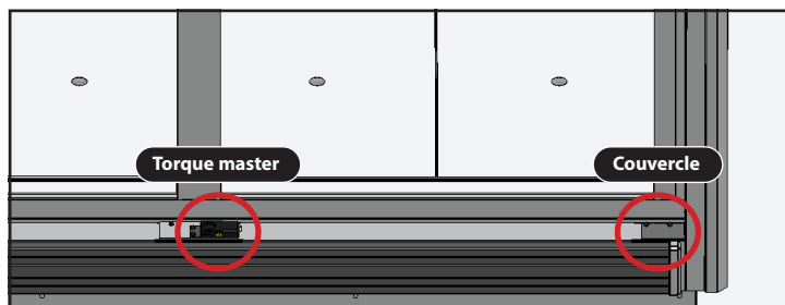
Fig. 25. Emplacements d'origine de l'ensemble de réglage de la fermeture de porte (torque master) et du couvercle.
