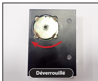
Fig. 26. Déplacez le torque master vers la plaque de rechange. Tournez dans le sens inverse des aiguilles d'une montre pour verrouiller ; dans le sens des aiguilles d'une montre pour déverrouiller.
