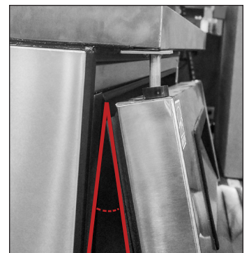
Fig. 10. Si es necesario, utilice solo ángulos reducidos al colocar la puerta.
