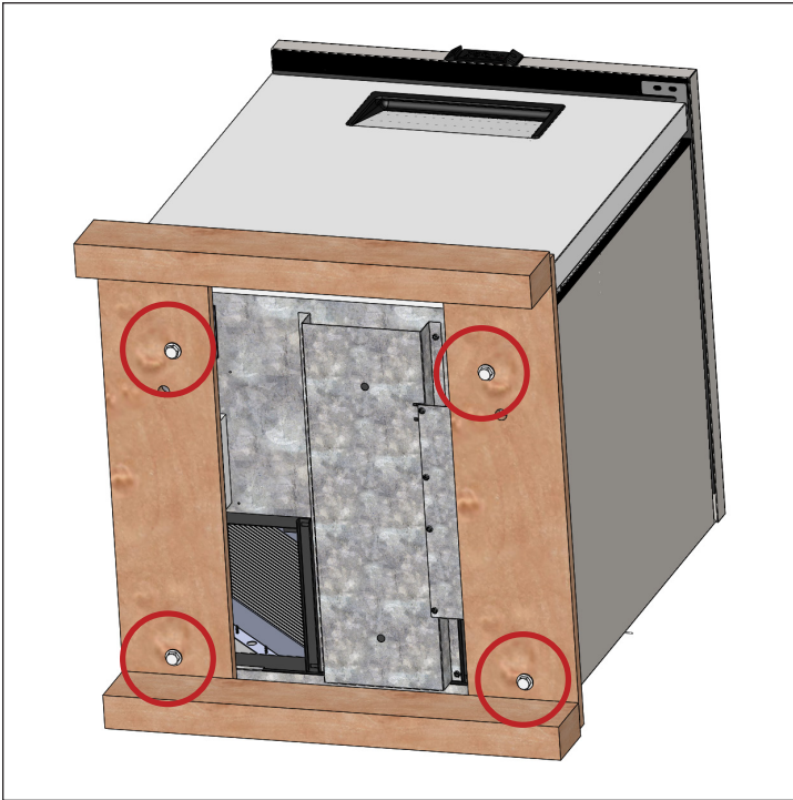
Fig. 3. Retire todos los pernos de transporte.
