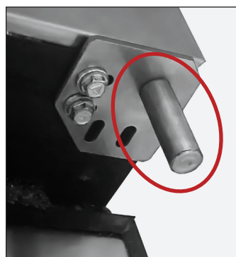
Fig. 2. Non rompere la boccola sulla cerniera superiore.
