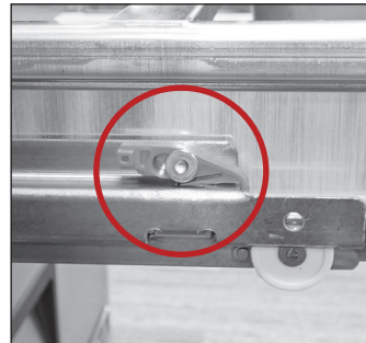
Fig. 5. Posizione del fermo del cassetto. Il fermo è inserito.
