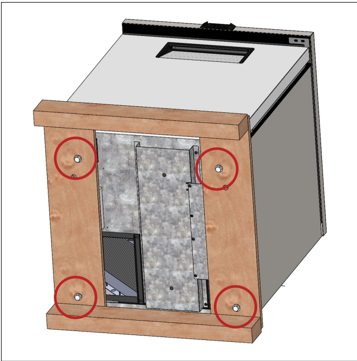
Afb. 3. Verwijder alle transportbouten.
