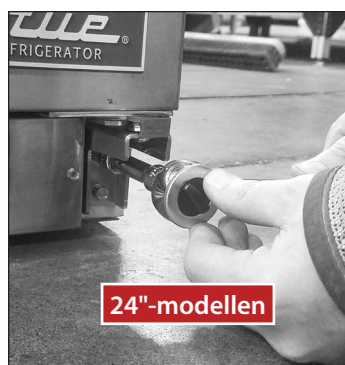
Afb. 1. De 24"- en 27"-modellen hebben andere scharnieren onderaan.
