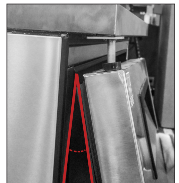
Afb. 10. Gebruik indien nodig een kleine hoek bij het positioneren van de deur.
