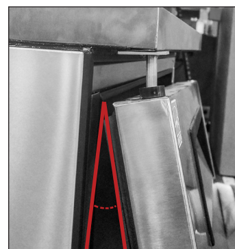
Rys. 10. Jeśli to konieczne, podczas ustawiania drzwi stosować wyłącznie płytke kąty.
