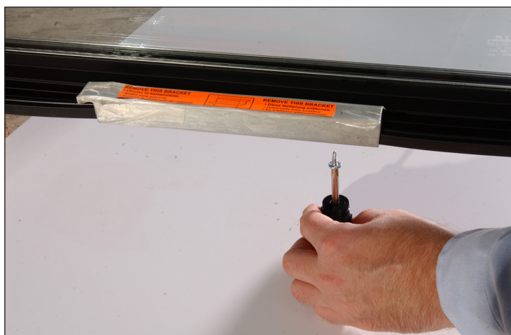
Rys. 2. Nie usuwać wsporników transportowych dopóki jednostka nie znajdzie się w miejscu docelowym.
