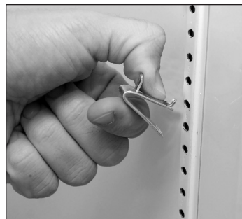
Rys. 1. Montaż górnego haczyka klipsa do półki.
