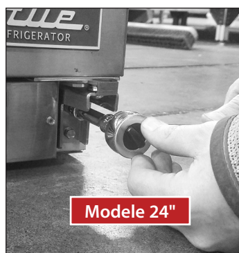
Rys. 1. W modelach 24 i 27 zastosowano inne zawiasy dolne.
