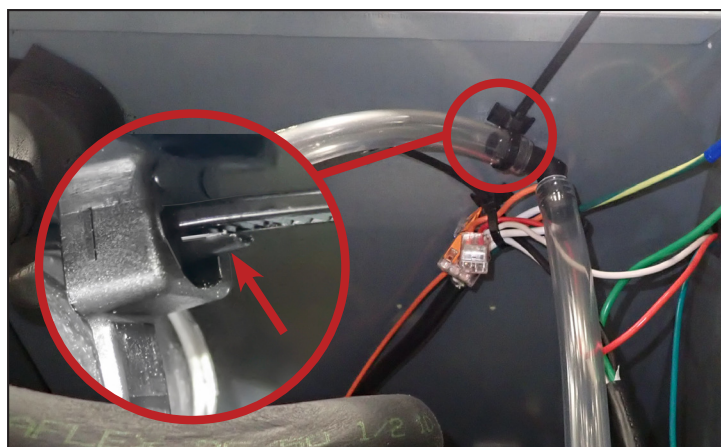
Рис. 3. Расположение фиксатора для открытия кабельной стяжки.
