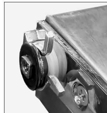
Рис. 7. Оставляйте шайбы в том же порядке, в котором они были изначально.
