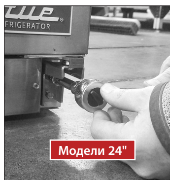
Рис. 1. В моделях 24 и 27 используются разные нижние петли.
