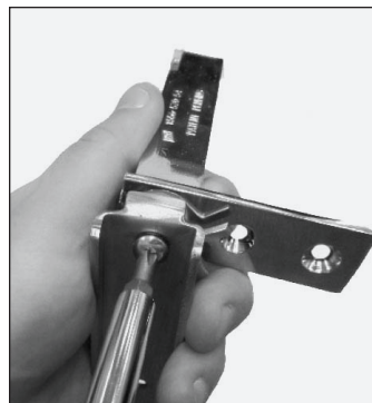
Рис. 6. Снимите кронштейн петли с помощью отвертки.
