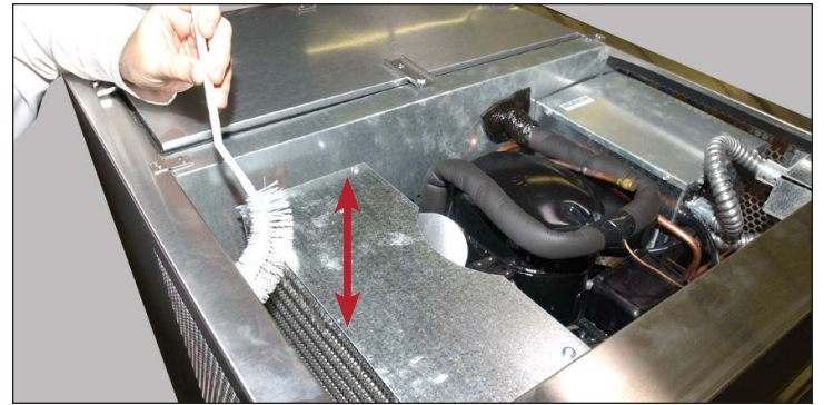
الشكل 2. إذا كان من الممكن الوصول إليها، نظف ملف المكثف. لا تستخدم الفرشاة أبدًا عبر زعانف السلك.
