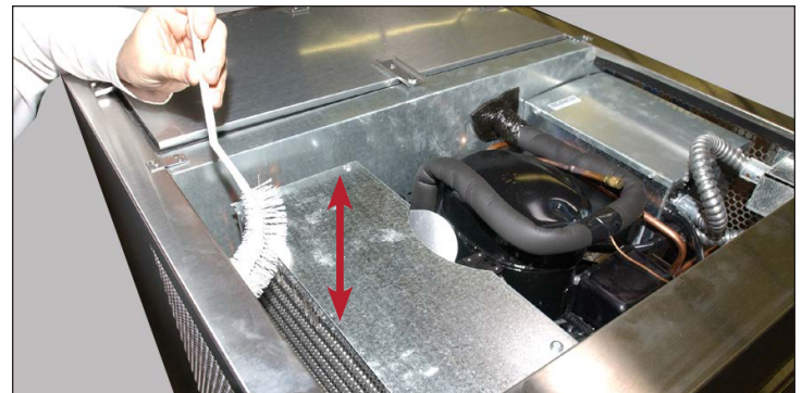
Afb. 2. Reinig de koelbatterij, indien toegankelijk. Nooit dwars over de spoelribben vegen.
