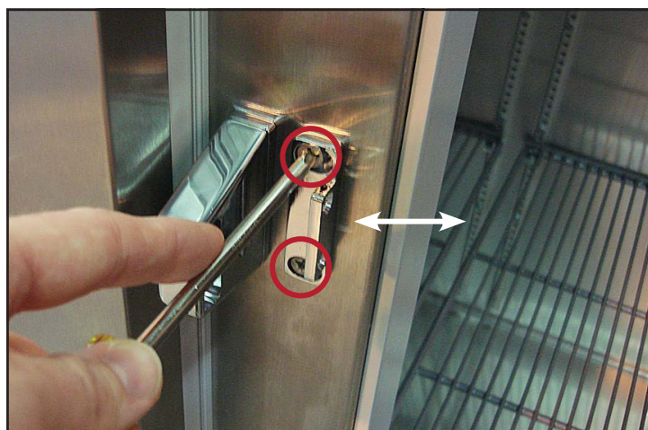
Afb. 6. Locaties schroeven bodem slot. Stel het vergrendelplaatje zijwaarts af
