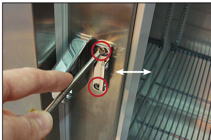
Figure 6. Emplacements des vis de la base de la gâche. Réglez latéralement le socle de serrure
