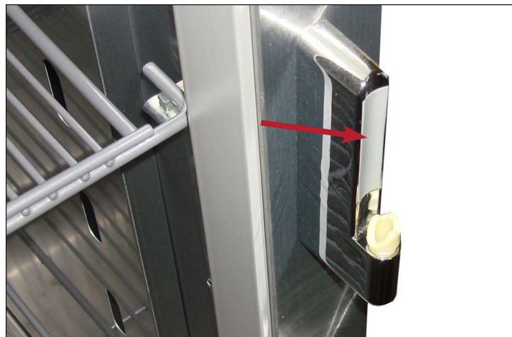
Figure 1. Démontez le capot de socle de charnière.
