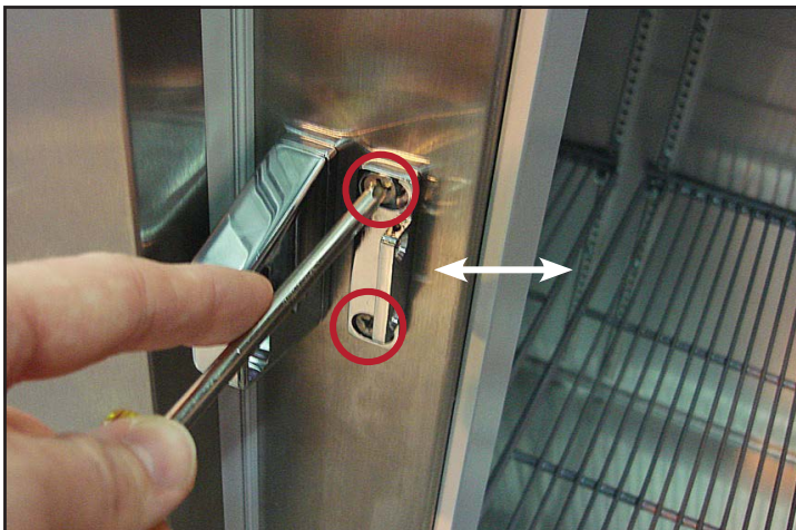
Abb. 6. Orte der Schlosssockelschrauben. Passen Sie den Schlossssockel zur Seite hin an.
