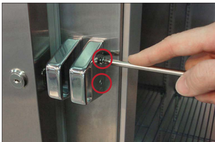
Rys. 5. Położenie wkrętów rygla zamka.
