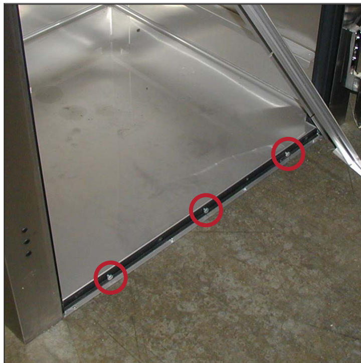
Rys. 1. Położenie śrub radełkowanych
