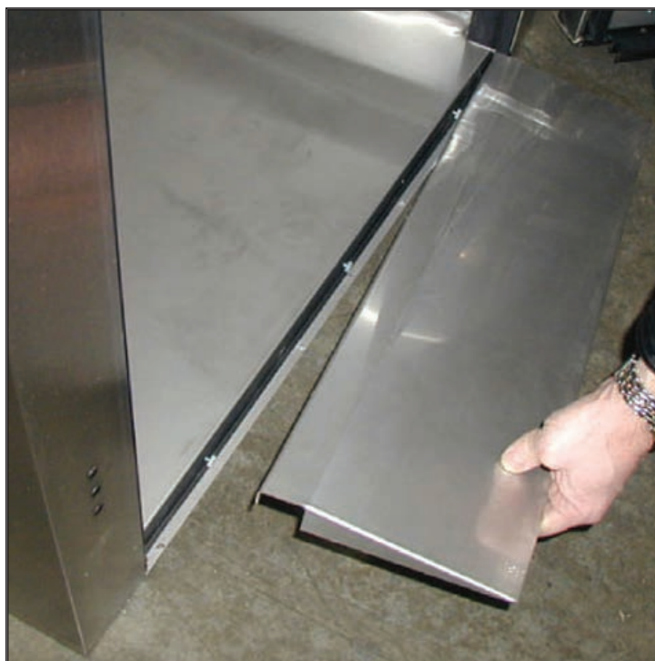
Рис. 2. Надеть пандус отверстиями на винты с накатанной головкой.
