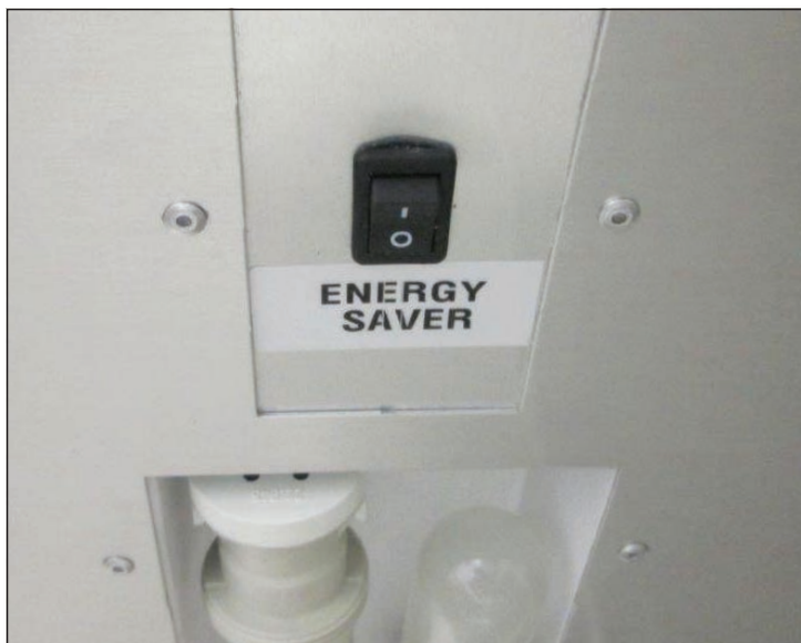
Рис. 1. Переключатель режима энергосбережения.
