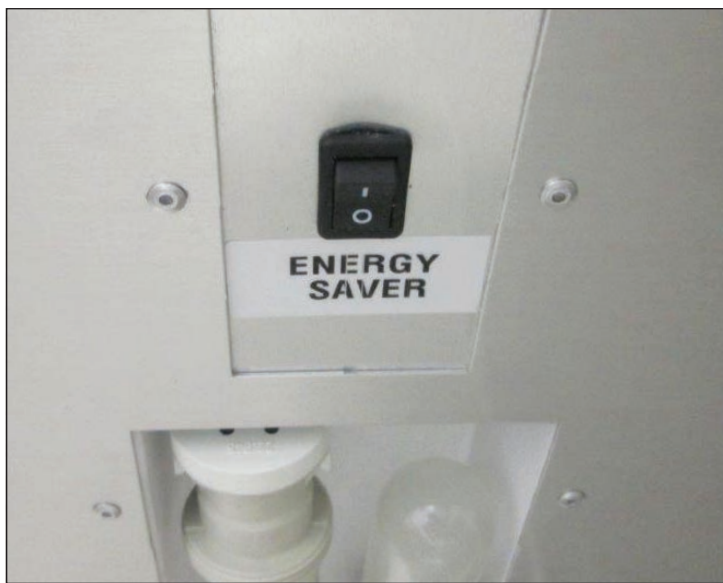
Fig. 1. Interruptor de ahorro de energía.
