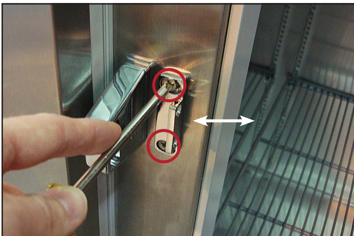
Fig. 6. Bloquee las ubicaciones de los tornillos de la base. Ajuste la base de la cerradura lateralmente
