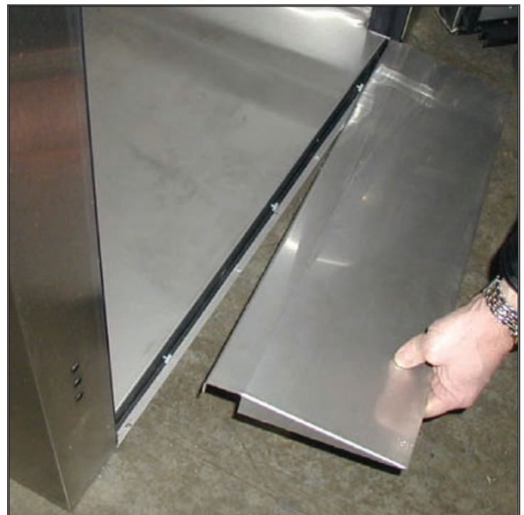
Fig. 2. Deslice la rampa sobre los tornillos de mariposa.
